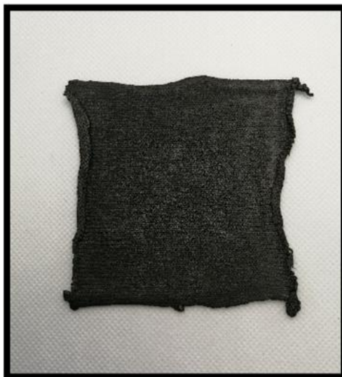
Figura 3: Immagine del tessuto in cotone impregnato con ossido di grafene ridotto (rGO)
