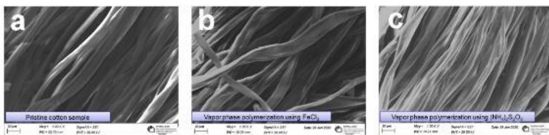
Figura 5: micrografie SEM del cotone non trattato (a), cotone dopo polimerizzazione wet con \text{FeCl}_3 (b), cotone dopo polimerizzazione wet con (\text{NH}_4)_2\text{S}_2\text{O}_8 (c)
