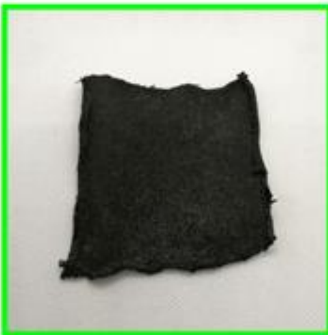
Figura 4: Immagine del tessuto in cotone impregnato con rGO/poliuretano
