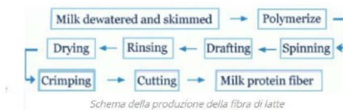
Figura 42. Schema della produzione della fibra di latte
