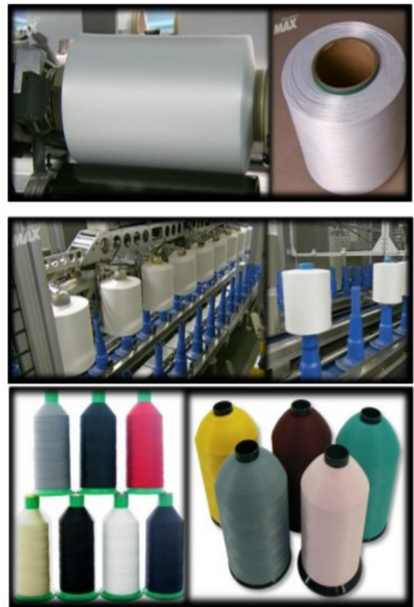
Figura 1. Filamenti di PET riciclato
